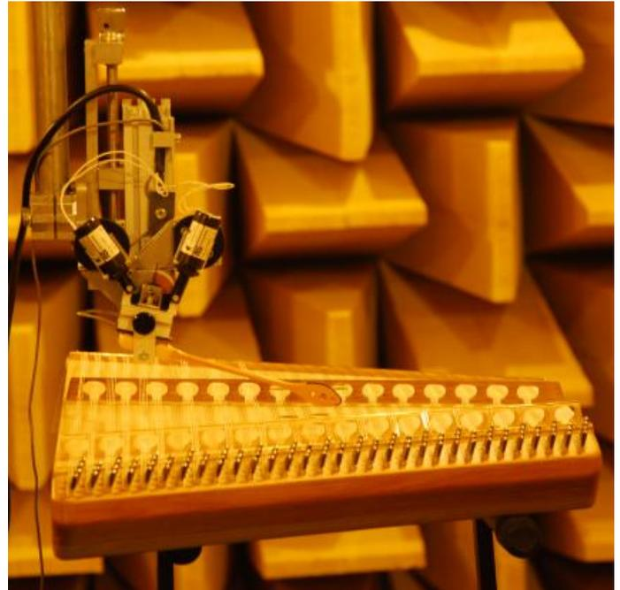
Abbildung 2 und 3: Anschlagautomat kurz vor dem Anschlag und zum Zeitpunkt des Anschlags
